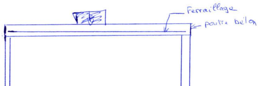
Un Ferrailage à une action particulièrement utile sur la contrainte à laquelle est soumise la partie inférieure
