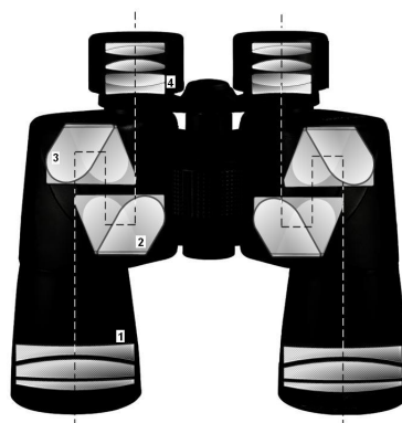
FIGURE 9 – Schéma d'une paire de jumelles (d'après Wikipedia) : le groupe 1 de lentilles constitue l'objectif, le groupe 4 l'oculaire.
